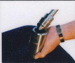
3.1 Halten Sie die MONRO in einer vertikalen Position, damit der Rotor nicht zu Boden fällt.
