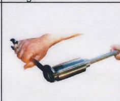
4.5 Die MONRO leicht mit einem Schraubenschlüssel anziehen.
