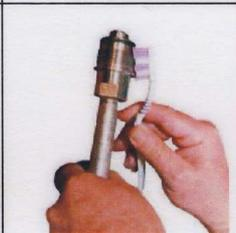
4.1 Wenn das Gewinde des Deckels mit Erde etc. verschmutzt ist, mit einer weichen Bürste reinigen.
