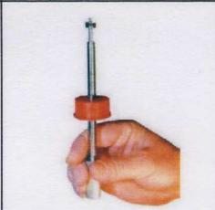
3.3 Den Sitz auf das Montagewerkzeug setzen und es vertikal halten.
